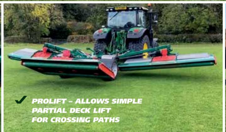
✓ **PROLIFT – ALLOWS SIMPLE PARTIAL DECK LIFT FOR CROSSING PATHS**
